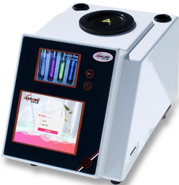
仪器：全自动熔点仪JH70、毛细管、研钵、长玻璃管
